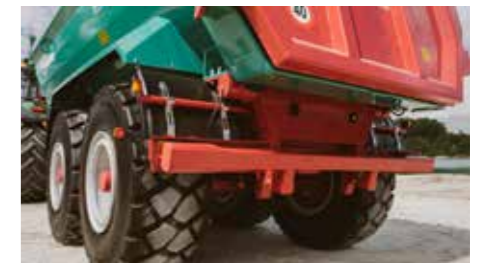
Unterfahrschutz und Beleuchtung
