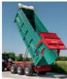
• Opcionala verzija dvostranog kipovanja Durus 2000S i Durus 3000S – kombinuje karakteristike bočnog kipovanja i kipovanja nazad
