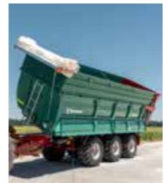
• Opcionala verzija dvostranog kipovanja Durus 2000S i Durus 3000S – kombinuje karakteristike bočnog kipovanja i kipovanja nazad
